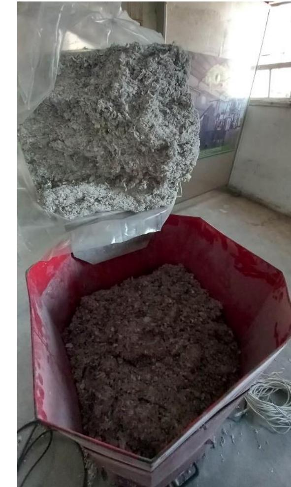
**Processus de fabrication de la Ouate de cellulose** : 01. Collecte de papiers et archives ; 02. Tri et transformation en Ouate de cellulose ; 03. Isolation des logements.
